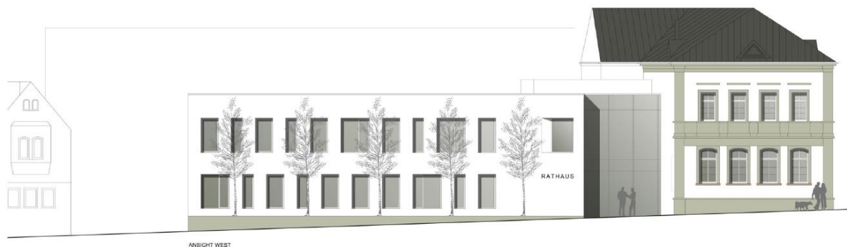
Abbildung 18: Neue Außenansicht des nun 2-stöckigen Anbaus und das durch eine Fuge freigestellte historische Rathaus.
